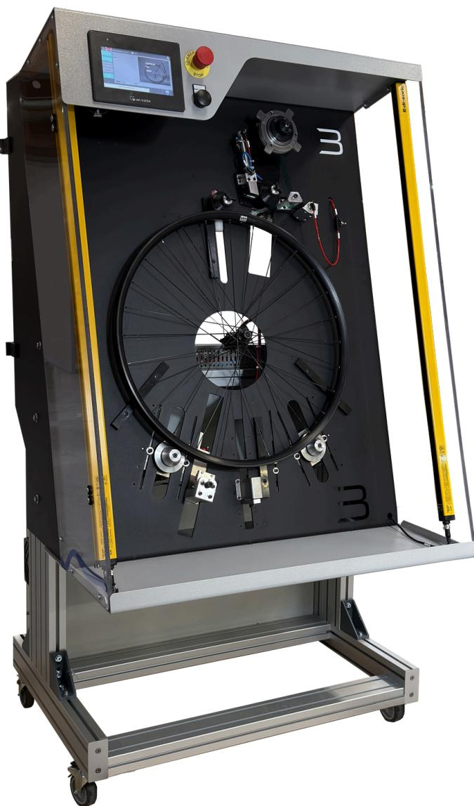
Machine de pose de fond de jante Tubeless
